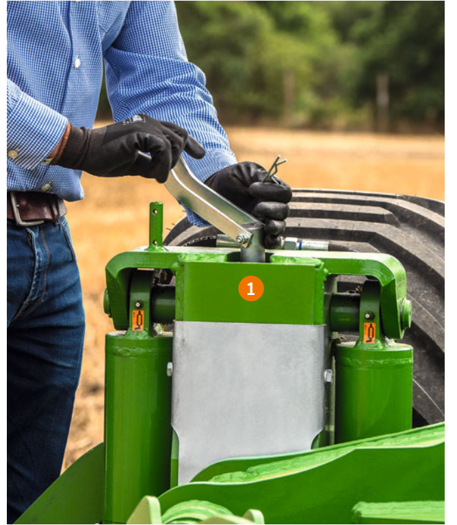
Destek tekerinde çalışma derinliği ayarı
